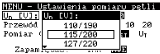
Rys. 9 Wybór napięcia znamionowego sieci
